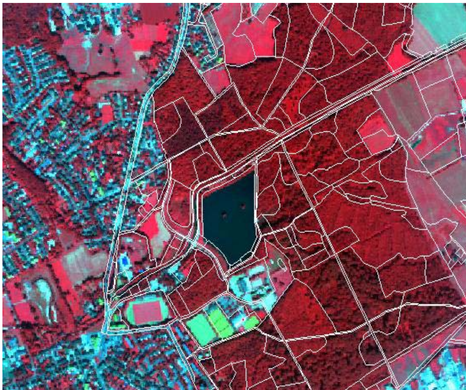
Bild 3. Ausschnitt geokodiertes HyMap-Bild überlagert mit GIS-Vektordatensätzen (Biotoptypen).
